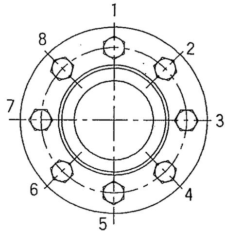
圖 3 螺栓的緊固順序例
