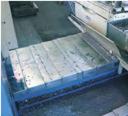
■ Teleskop-Abdeckung mit Flachform an einem Bohrwerk
