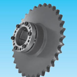
ボルトを締付けることでテーパスリーブの摩擦力により、キー無しでスプロケットを軸に締結します。位相合わせも容易です。
