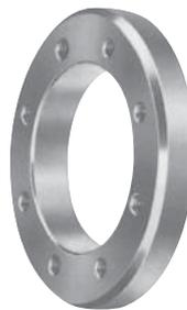
パワーロック SL は、テーパリング A、B の内径およびインナリングの外径はテーパになっており、締付ボルトを締付けることによりテーパリング A、B はテーパ面を摺動しながら移動します。
