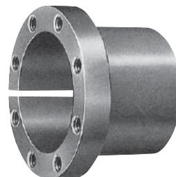
パワーロック TF は、インナリング、アウトリング、スペーサ、締付ボルトの4部品で構成され、締付ボルトを締付けるだけで強力に締結できます。
