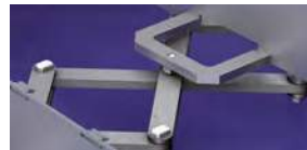
5 Gleichlaufeinrichtung (Scheren) bei schnell laufenden Teleskop-Abdeckungen
