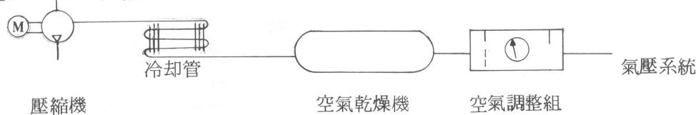
由乾燥機出來之空氣再進入空氣調理組，再次過濾，再經調壓與潤滑後出來之壓縮空氣再進入氣壓系統，如此可使系統內之各氣壓元件獲得較佳之壓縮空氣，當然對系統內之元件有較佳的保護。
