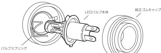
3 車体側から伸びている電源ソケットをLEDバルブソケットへ差し込みます。
