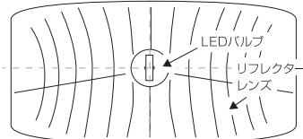
ヒートシンクから出ているハーネスを中心部の真下にして固定することでヘッドライトユニット(正面)の図のようにLEDバルブの先端がリフレクターに対し垂直になります。
