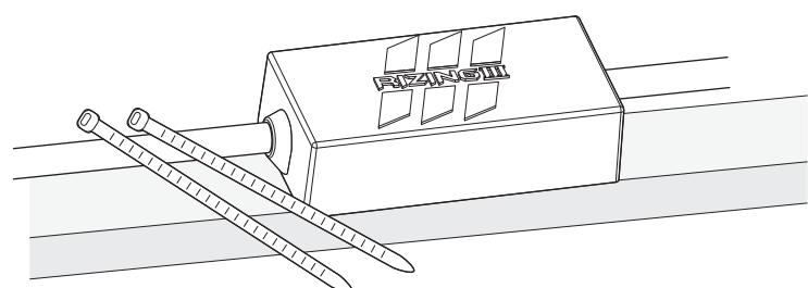
コントローラーケースの側面から結束バンドを通し、車両側ハーネスやフレームを利用し、輪を作り固定します。
