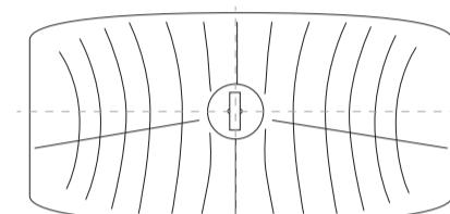
ヒートシンクの合いマークを真上にして固定することでヘッドライトユニット(正面)の図のようにLEDバルブの先端がリフレクターに対し垂直になります。
