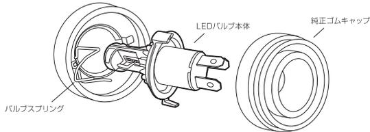
3 車体側から伸びている電源ソケットをLEDバルブソケットへ差し込みます。
