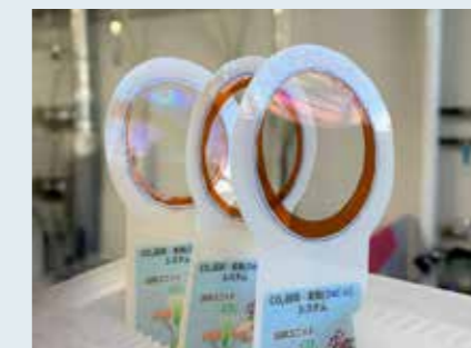
髪の毛のわずか300分の1の厚さの分離膜
