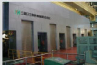
武漢鋼鉄にて建設中のものと同タイプの電磁鋼板用連続冷間圧延機
