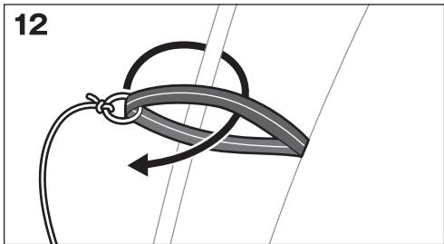
本体フレームA(短)に張綱用ループを巻き付け、ペグダウンします。
