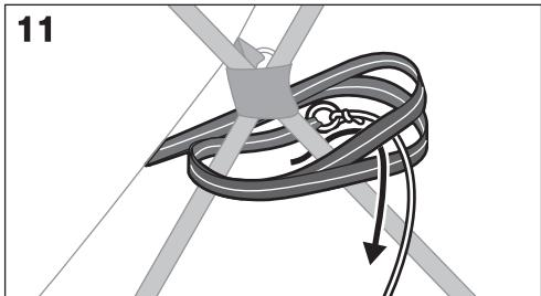
本体フレームB(長)の交点に張綱用ループを巻き付け、ペグダウンします。
