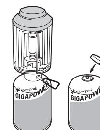
■ 理由 ■器具栓が不用意に開きガスが漏れことがあります。器具並びにガスカートリッジの接続部分にゴミやホコリが付着すると故障の原因になります。
