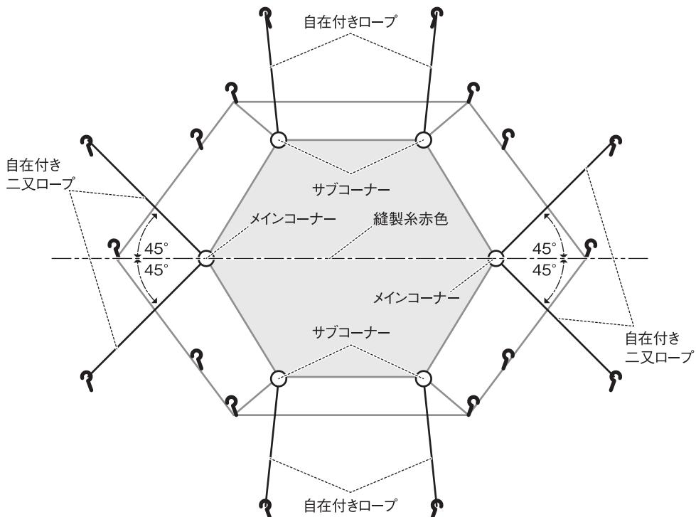
メインコーナーのロープ間の角度が $90^{\circ}$ 以上広い位置でペグダウンするとポールにテンションが伝わらず、正しく設営することができなくなりますので注意してください。ペグダウンはタープからできるだけ遠くに行ってください。設営したとき、ロープの角度が地面に対し約 $45^{\circ}$ となるのが理想的なペグダウンの位置です。〔図A〕また、ペグを打ち込む角度はロープに対して $90^{\circ}$ になるようにペグダウンします。〔図B〕
