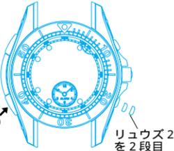
警告音が「ビビッ」となりアラーム小時計がリュウズ2を2段目まで引き出した時の時刻を表示して止まります。リュウズ1は必ず通常位置に押し込んでおいてください。
