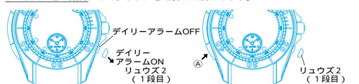
リュウズ2を1段目に引き出してください。アラーム小時計は以前セットしたデイリーアラーム時刻を示します。アラームセット時刻を変えない場合はこれでセット完了です。現在時刻がアラームセット時刻になるとアラーム音が約20秒間鳴ります。鳴っているアラーム音を止める場合はボタン(A)(B)(C)のいずれかを押ししてください。
