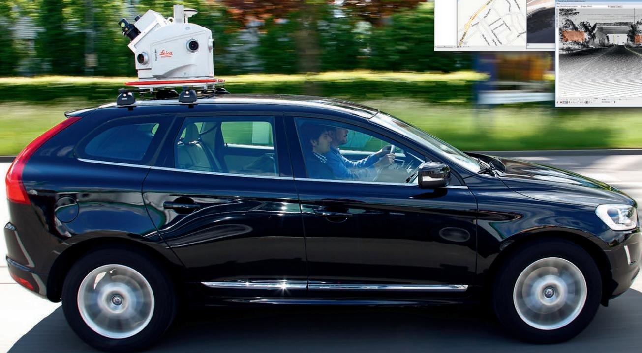
Leica Pegasus:Two は、ビジュアルイメージの操作性と信頼性に点群データの高い精度を車両速度で統合し、半自動データ抽出ツールで即 GIS で使用できるインターフェースへと変換します。
