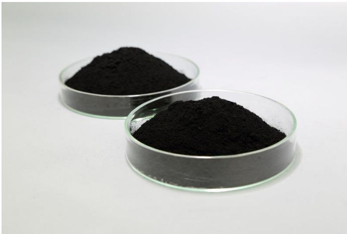
Elektrodenkatalysatoren aus Platin steigern die Leistungsfähigkeit von gestapelten Brennstoffzellen.
