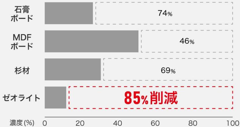
ゼオライトのアンモニアガス吸着試験結果
