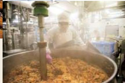
一度に約千~3千人分作れる大きな調理釜(右写真)や、しっかり熱を通しておいしい揚げ物を作るフライヤー(上写真)など、普段目にすることのない専用の調理器具は、お弁当の製造現場ならでは。調理後は、おいしさを閉じ込め、食品中の微生物の繁殖を防ぐために、急速冷却設備を使って冷やします。
