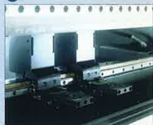
④ 先端微調整付き突き当て
