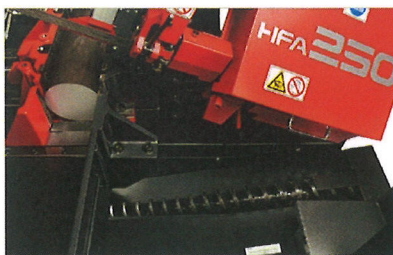
チップコンベヤー
