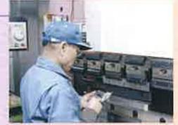
図面から形状を認識し、頭の中で使用金型を想定し、曲げ順を考えデータ入力します。干渉チェックは主にリターンバンド模型で確認します。
