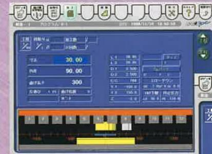
金型レイアウトの設定が可能です。曲げ位置を設定することで、左右・中央の圧力も自動計算されます。金型レイアウトを表示させながら自動運転することができ、曲げ位置を確認しながら加工することができます。
