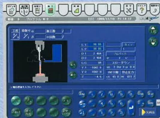
側面からのシミュレーション画面を表示させながら自動運転することができ、ワークの形状と突き当て方向を確認しながら加工することができます。
