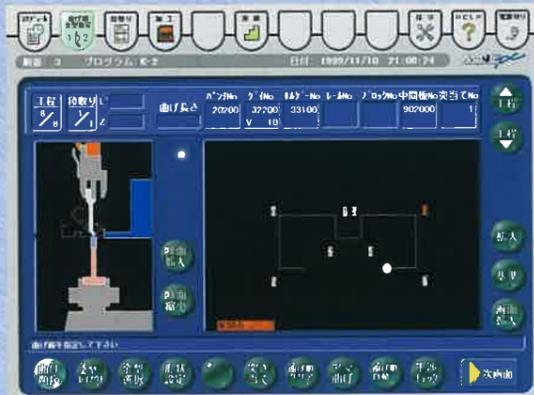
曲げ点と突き当て点をタッチすることで、曲げ順序を決定します。このとき、金型選択も行います。曲げ順序と金型種類を自動設定することも可能です。
