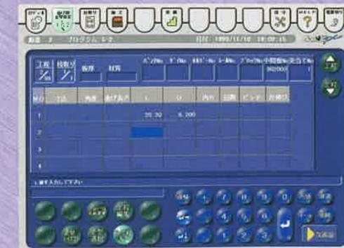
曲げ条件を入力することなく、バックゲージ位置決め寸法「L」とテーブル位置決め寸法「D」を直接入力。あとは実際にハンドル操作により加工品を曲げることでデータを設定します。
