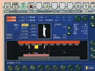
使用する金型を確認した上で、金型のセット・原点出しが行えます。
