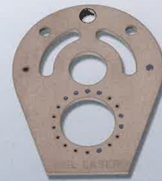
特殊金属サンプル 適用発振器:20XF/32XP/45CF-R 純ニッケル t2mm
