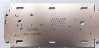
複合加工サンプル 適用発振器:20XF/32XP/45CF-R SECC t1.2mm
