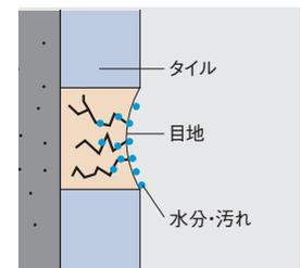
目地はセメント基材なので、ひび割れが生じ、カビが発生しやすい。
