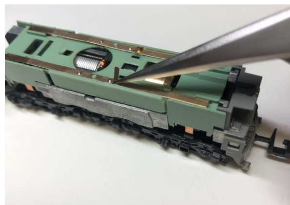
モーター集電シューを少し外側に曲げます。
