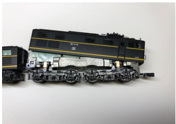
ボディを被せます。運転台側から引っ掛けるように被せるとうまく取り付けることができます。
