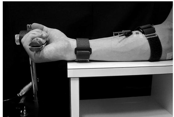
図2 FDPに対する一定強度電気刺戟による握力の測定
