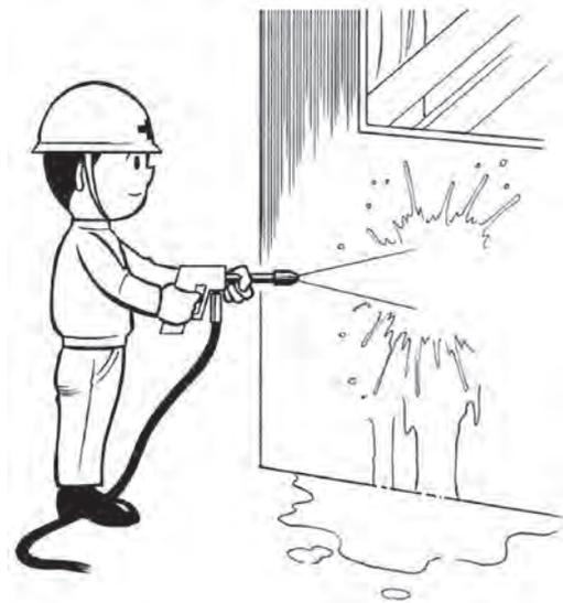
図 1-2-10 汚れ及び劣化した部分の除去 (高圧水洗)
