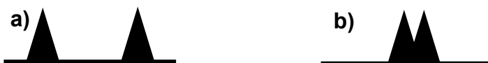
図2: LR-HSQMBC(non dec)の信号パターンの模式図 a) 大きなカップリング、b) 小さなカップリング
