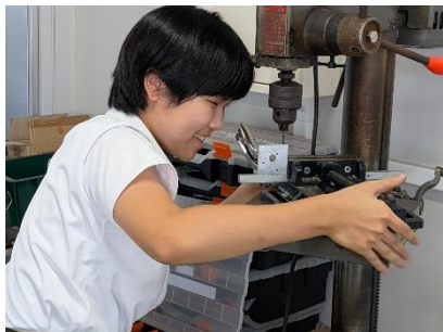
穴あけ作業(バイス使用)
