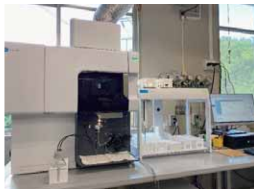
写真3 ICP発光分光分析装置 土壌、植物体等の成分分析を行います。
