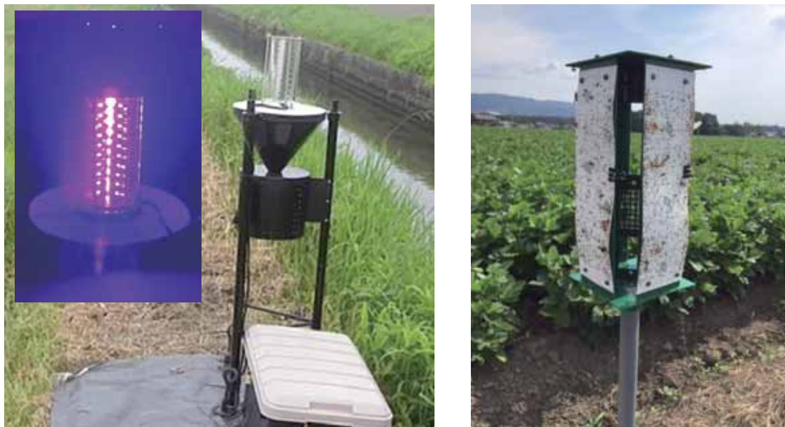
図4 調査に利用しているUV-LEDトラップ（左）とフェロモントラップ（右）
