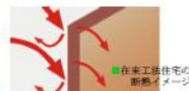
■ドームハウスの素材である発泡ポリスチレンは空気を多く含み、ドームハウス素材の場合95%が空気です。空気が多く含まれることで密度と断熱性の変化が伝達にくく、しかも壁の厚さが20cmもあり、さらに内外を特殊な皮膜で覆っているため断熱性抜群です。
