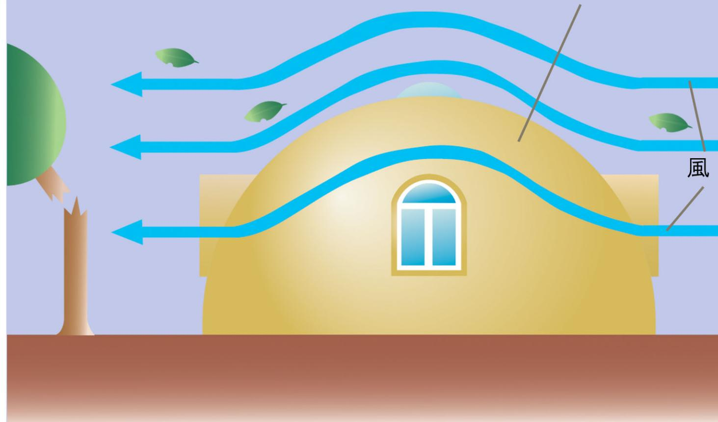
形状が流線型のドーム型のため、風をまともに受けにくくなっています。さらに、発泡ポリスチレンの底部をカギ状にして、コンクリート基礎に埋めることで、非常に強い台風にも耐えうるのでです。
