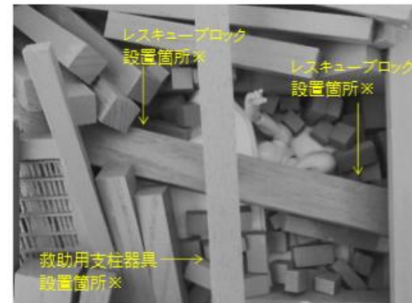
写真 2-1-13 救助用支柱器具等の設置箇所（梁の下部に設置）（模型による再現）
