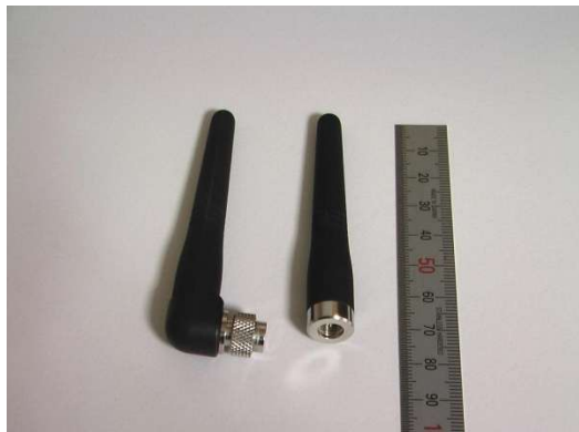
【スリーブアンテナ AT2402S G = 2 \text{ dBi} 】
