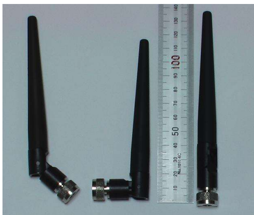
【屈曲型スリーブアンテナ AT2402SPU G = 2 \text{ dBi} 】【大小ホイップアンテナ AT2407S G = 7 \text{ dBi}, 5 \text{ dBi} 】
