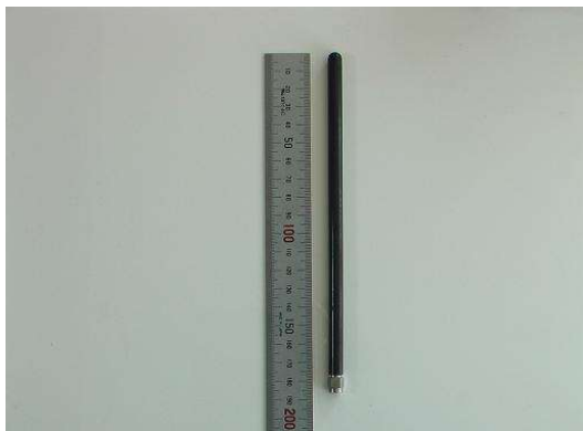
【コーリニアアンテナ AT981 G = 4 \text{ dBi} 】
