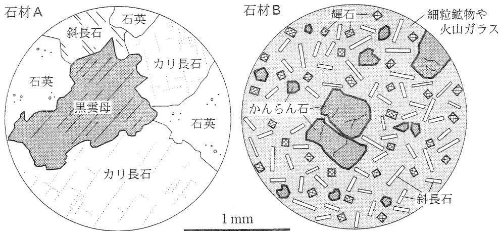
図3 石材Aと石材Bのプレパラート(薄片)を偏光顕微鏡で
