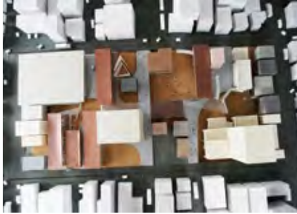
■複雑に錯綜する動線や、建築物のボリューム、建築材料の見え方を検討するため、1:100の模型で検討を行った。
