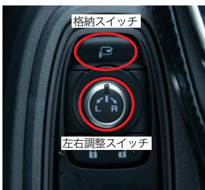
② 格納スイッチでドアミラーが開閉します
