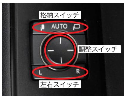
② 格納スイッチでドアミラーが開閉します
