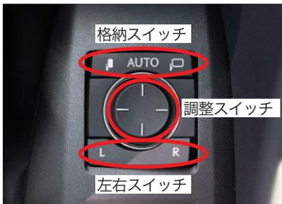
② 格納スイッチでドアミラーが開閉します
