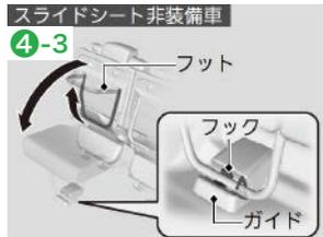
座面を静かに前方に倒して、フットをガイドに入れます。(写真④-4)
