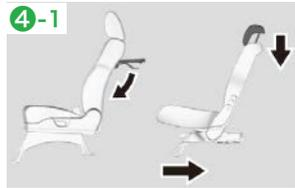
背もたれのレバーを引き、前方に倒します。(写真④-2)
