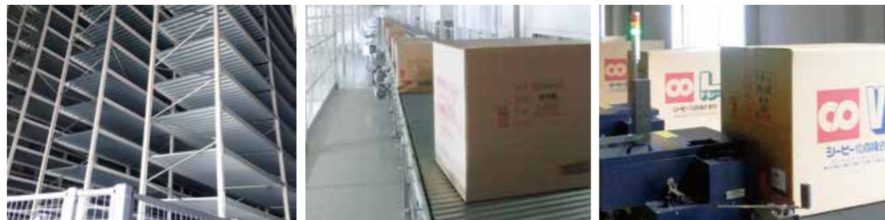
自動ラック倉庫
