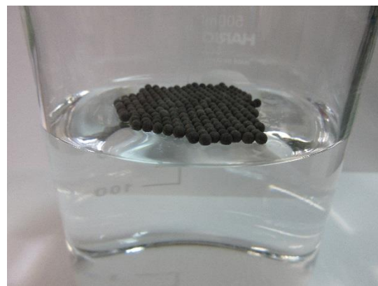
Hydrophober, auf Wasser schwimmender Edelmetallkatalysator100
