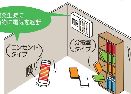
地震発生時や電気復旧時の火災発生を防ぐため、感震ブレーカーを設置しましょう。
