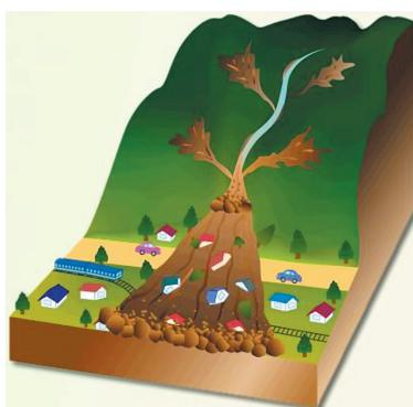
山腹が崩壊して生じた土石又は溪流に堆積した土石等が一体となって流下する現象です。
