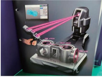
ハンディプローブ三次元測定機 XM-C5000
