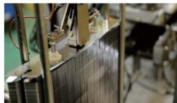
私たちの根幹である鋸製造に特化し、輸出・国内用の高儀オリジナル製品の企画・製造、ストアブランドなどのOEM製造を行っています。歯の目立て・バリ取り・洗浄・焼き入れ・名入れ・コーティングなどの製造ラインは完全自動化。汎用機のカスタマイズだけでなく、オリジナル開発機の導入も行い、他社との差別化を図っています。
