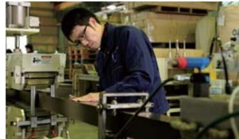
高儀オリジナル製品「ネオカットウッド」の製造を行っています。製材所で出たおがくずとペットボトルの再利用素材で作ったペレットと溶剤を混ぜて製造する人工木を、フェンス、デッキ、ボールなどの建築材料に加工。エクステリア業界に卸し、住宅・公共施設などに広く使われています。
