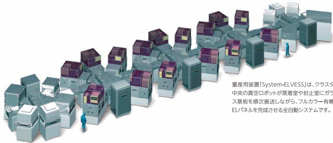
量産用装置「System-ELVESS」は、クラスタ中央の真空ロボットが蒸着室や封止室にガラス基板を順次搬送しながら、フルカラー有機ELパネルを完成させる全自動システムです。
