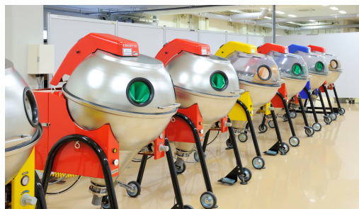
▲見た目が最高にかわいい「ココット」。これもウェットブラスト装置！バイクのパーツの洗浄等に使われたりします
