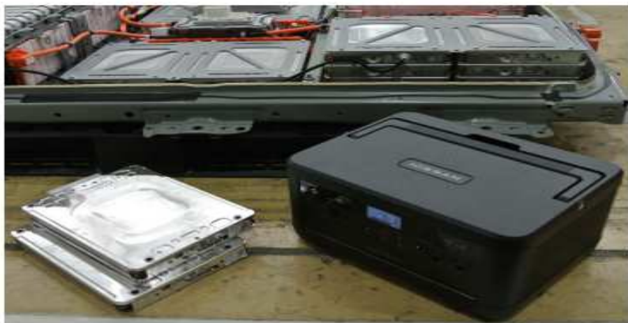
製品に使用される「日産リーフ」の再生バッテリーセル(左)と開発中の製品イメージ(右)
