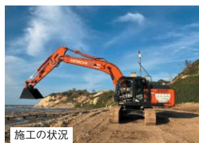
遠隔操作による施工(安全・省力化)
